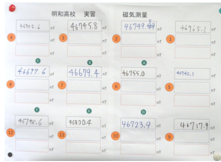
図1：実習記録用紙。オレンジの丸が観測点位置、緑の丸が「お宝」の埋蔵候補位置。測定結果から、6個の緑丸のうち、どこにお宝が埋まっているか推測します。
