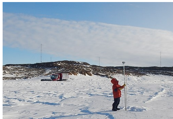
写真5：圧雪車の車両磁気モーメント測定の様子
