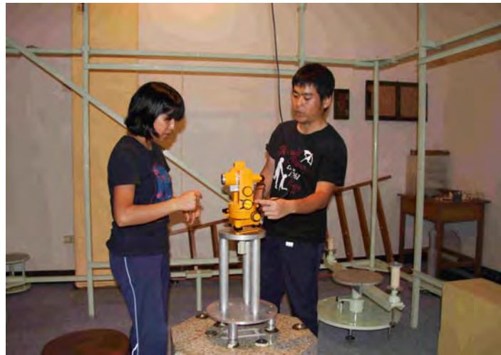
写真1 FT型磁気儀による絶対観測習得訓練の様子(対応は技術課井技官(右))
