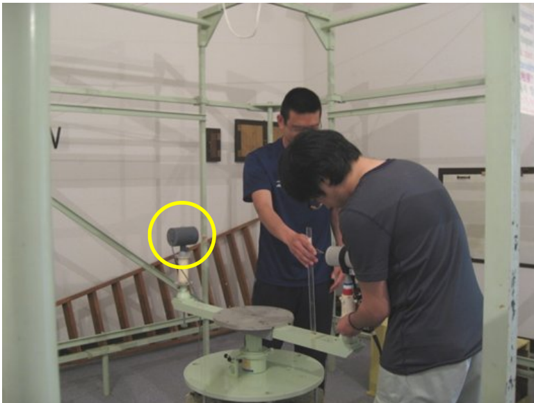
写真1 比較観測を行うプロトン磁力計をセッティングする様子。 黄色の で囲んでいるのは全磁力基準器。
