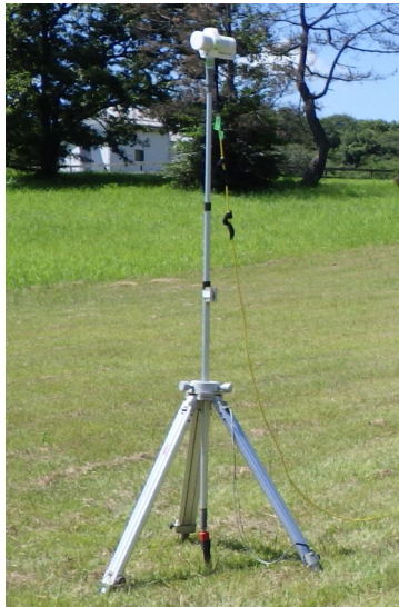
写真3：地磁気の大きさを測定する器械 (左) プロトン磁力計、(右) オーバーハウザー磁力計
