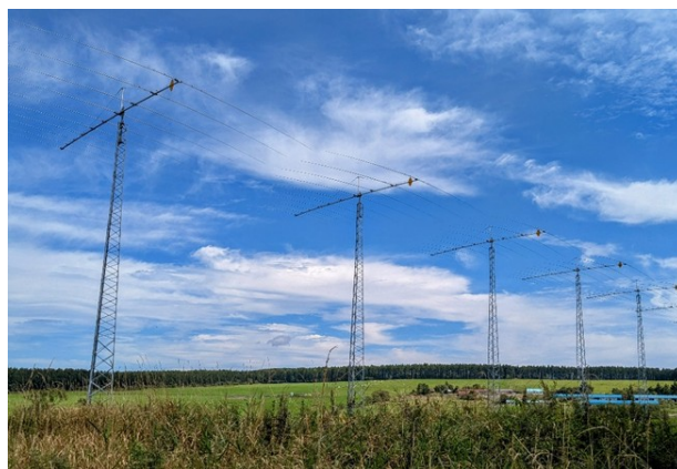
写真3：北海道陸別町にある超高層大気の動きや電場の分布などを観測するHF（短波）レーダーの観測施設
