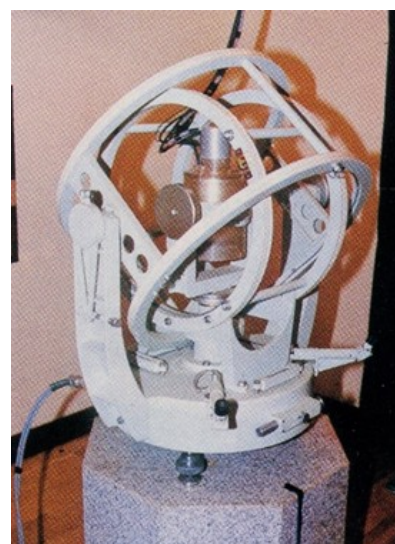
写真6：稲田石の器械台と 光ポンピング磁力計
