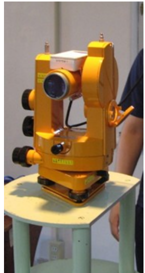
写真4：地磁気の向きを測定する器械 (角度測定器・経緯儀)
